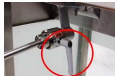
○ Palanca ajustada mantiene la cabeza en ángulo 0°
