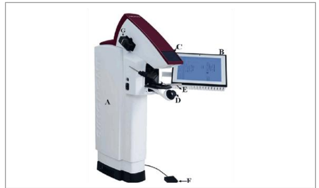
Figura 14.- Simulador virtual háptico Simodont®.
